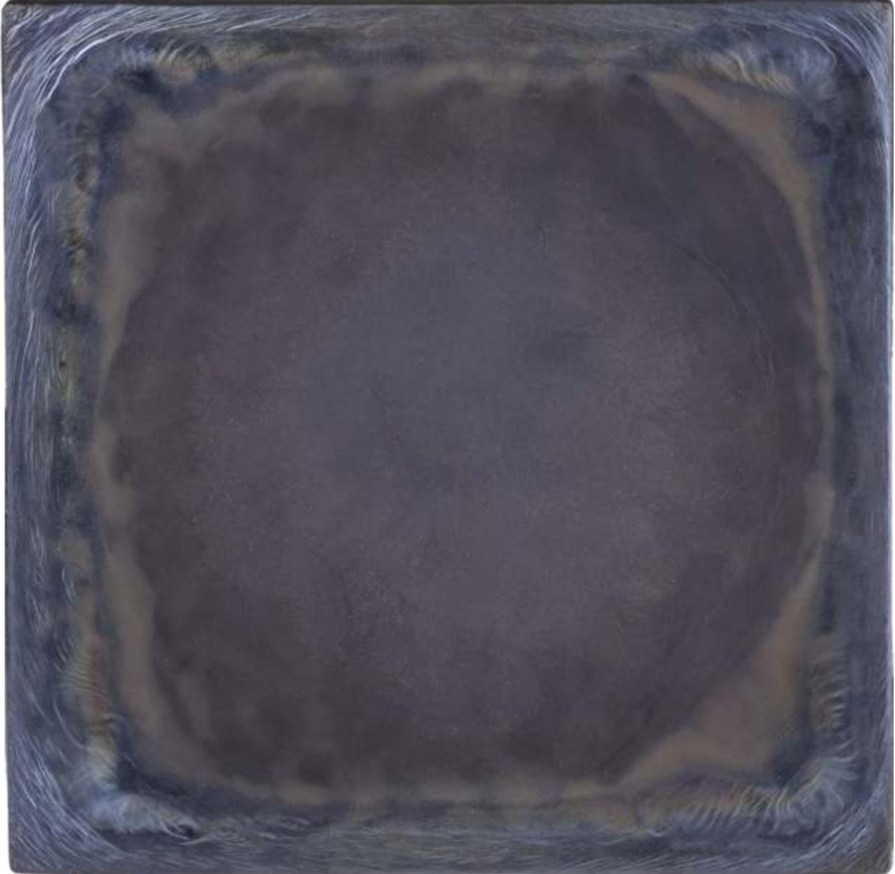
**Platten aus Basalt in den Abmessungen 200x200 oder 250x250 mm,
